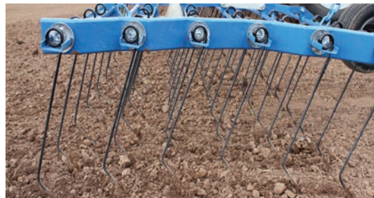
Der Striegel ist ein wichtiges Gerät zur mechanischen Unkrautbekämpfung im Ackerbau. Hier Blindstriegeln in Erbsen.
