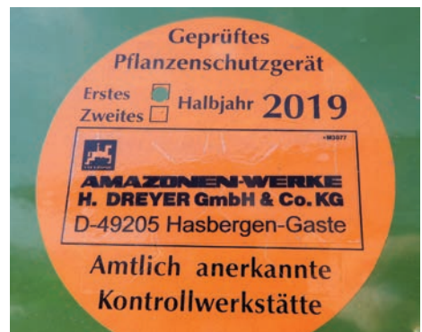
Prüfplakette an einer Pflanzenschutzspritze
